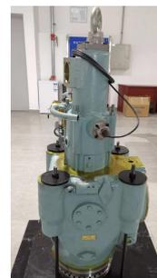
ME 电喷柴油机排气阀总成
