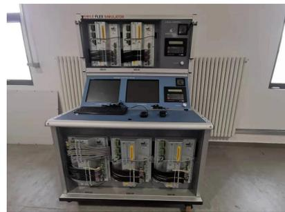
RT-FLEX 电喷柴油机模拟器
