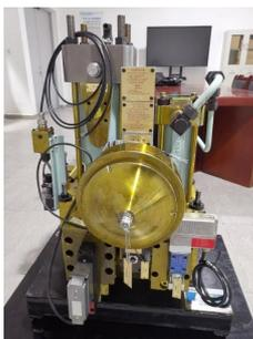
ME 电喷柴油机液气缸单元
